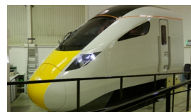
IEP 車両の 先頭形状 モックアップ
